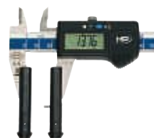
Mesure d'écart d'alésages
